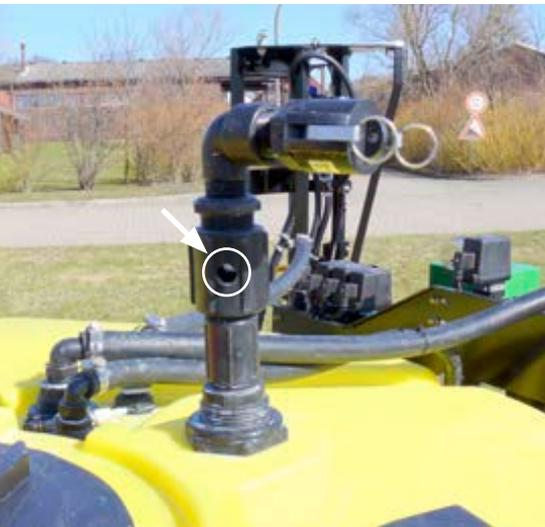
Bild 2: Der Einsatz der freien Fließstrecke verhindert ein Zurückfließen der Spritzflüssigkeit ins Leitungsnetz.
