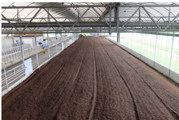
Kompostierungsstall für Milchkühe: links frisch gegrubberte Fläche – rechts Grubbarbeiten.
