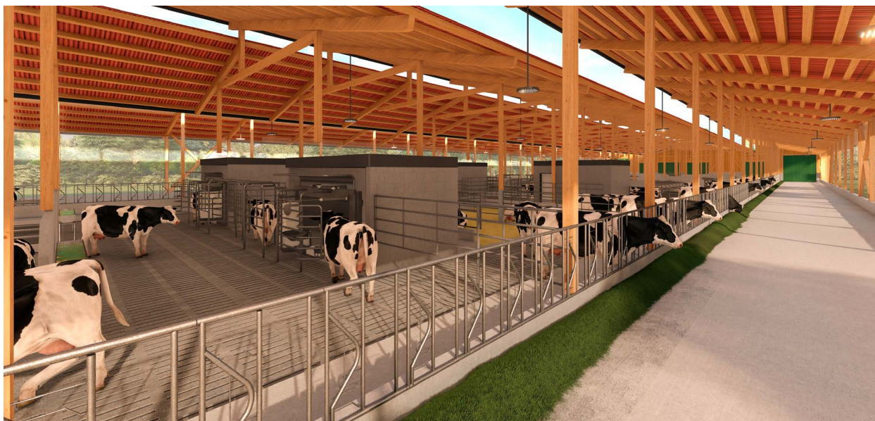
Blick auf den befahrbaren Futtertisch im Ökonomiestall.
