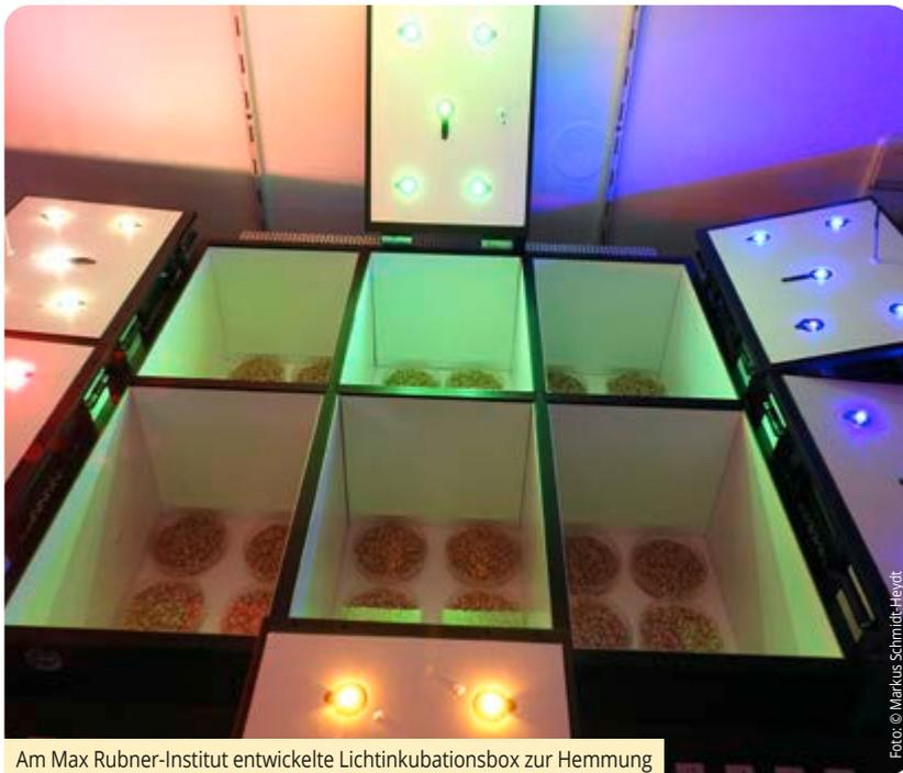
Am Max Rubner-Institut entwickelte Lichtinkubationsbox zur Hemmung von Schimmelpilzen und Reduzierung der Mykotoxin-Bildung
