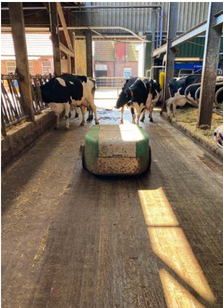
Abbildung 15: Roboter halten die Laufflächen sauber und reduzieren dadurch die Emissionen.
