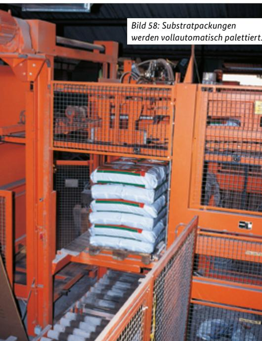
*Bild 58: Substratpackungen werden vollautomatisch palettiert.*
