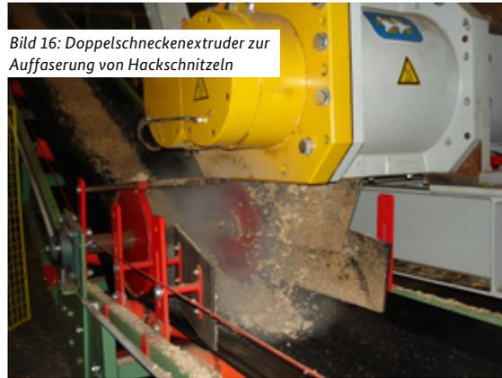
Bild 16: Doppelschneckenextruder zur Auffaserung von Hackschnitzeln
