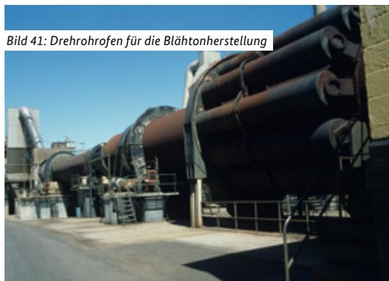
*Bild 41: Drehrohrofen für die Blähtonherstellung*
