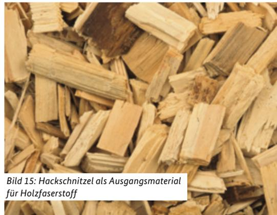
Bild 15: Hackschnitzel als Ausgangsmaterial für Holzfaserstoff
