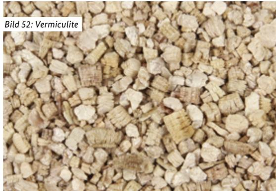
Bild 52: Vermiculite
