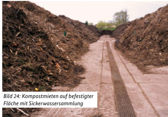
Bild 24: Kompostmieten auf befestigter Fläche mit Sickerwassersammlung
