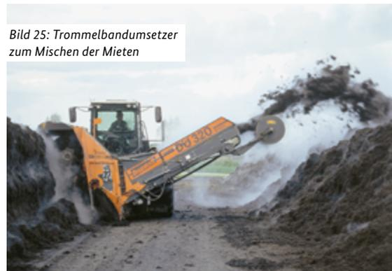
Bild 25: Trommelbandumsetzer zum Mischen der Mieten
