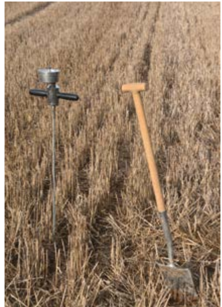
Abbildung 44: Verdichtungshorizonte können über Bodensonden mit Druckanzeige oder mit der Spatenprobe ermittelt werden.
