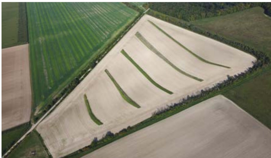
Abbildung 62: Ein großflächiges Wasserliniensystem nach dem Keyline-Ansatz in Thüringen, bestehend aus Retentionsgräben mit Agroforst-Bepflanzung. Planung und Umsetzung durch die Firma baumfeldwirtschaft.de.
