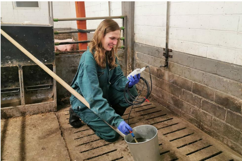
Abb. 1: Messung des pH-Wertes in einer Flüssigmistprobe (© Overmeyer/Universität Bonn).
