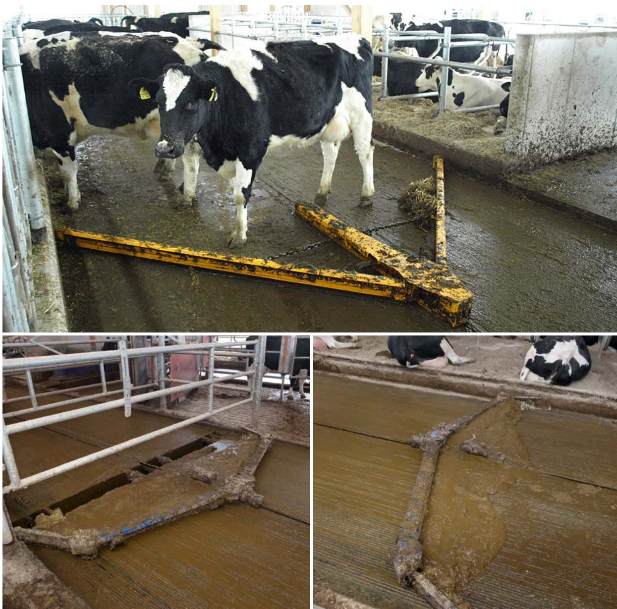
Faltschieber (oben)/Klappschieber (links) zum Abschieben der Gülle auf planbefestigten Laufflächen: Der entstehende Güllesee (rechts) stellt in Bezug auf Emissionen und Klauengesundheit ein Problem dar.
