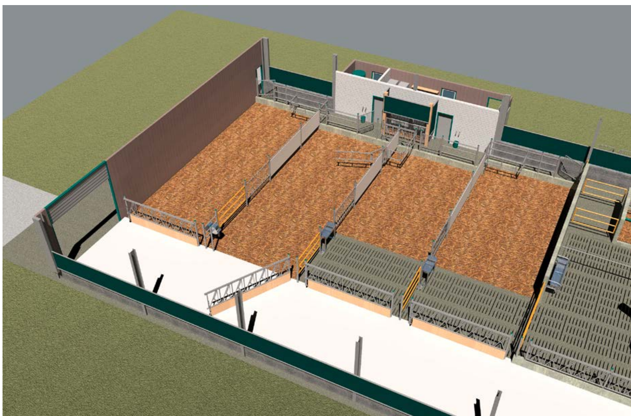
Einflächenbuchten mit Stroh (links) sowie Zweiflächenbucht mit Stroh und Spalten (rechts).
