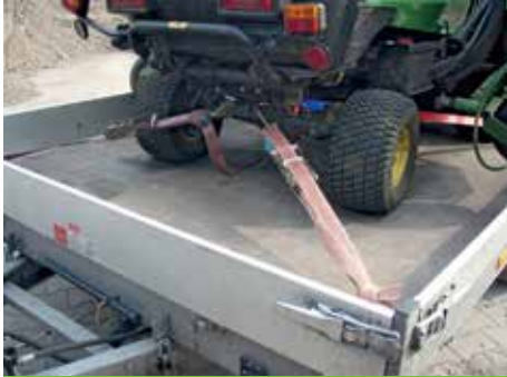
Bild 11: Maschinen und Geräte werden meistens direkt (diagonal) verzurrt.
