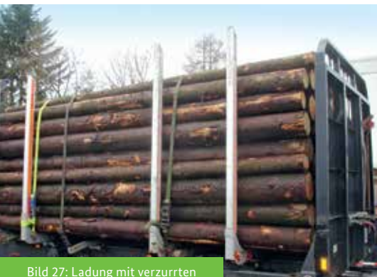
Bild 27: Ladung mit verzurrten Baumstämmen zwischen Rungen
