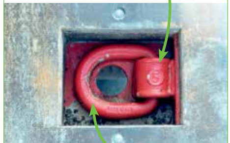
Bild 16: Befestigung für Zurrgurt, mit eingepprägter Zugkraft in t
