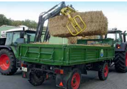
Bild 9: Die erste Lage Strohballen liegt formschlüssig im Anhänger; werden weitere Ballen darauf geladen, so ist für diese eine Sicherung mit Zurrgurten erforderlich.
