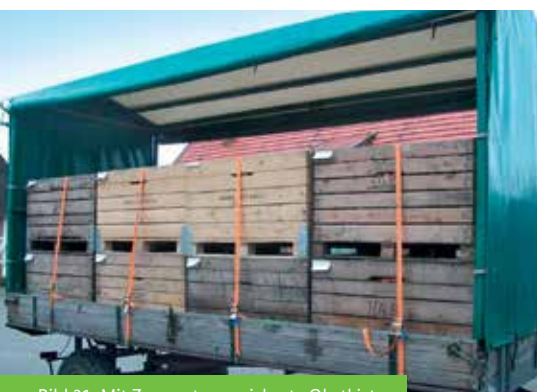
Bild 31: Mit Zurrgurten gesicherte Obstkisten
