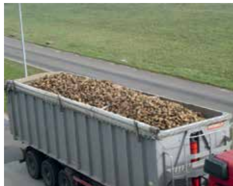
Bild 10: Bei Schüttgütern besteht allseits Formschluss, außer im Bereich des Ladekegels.
