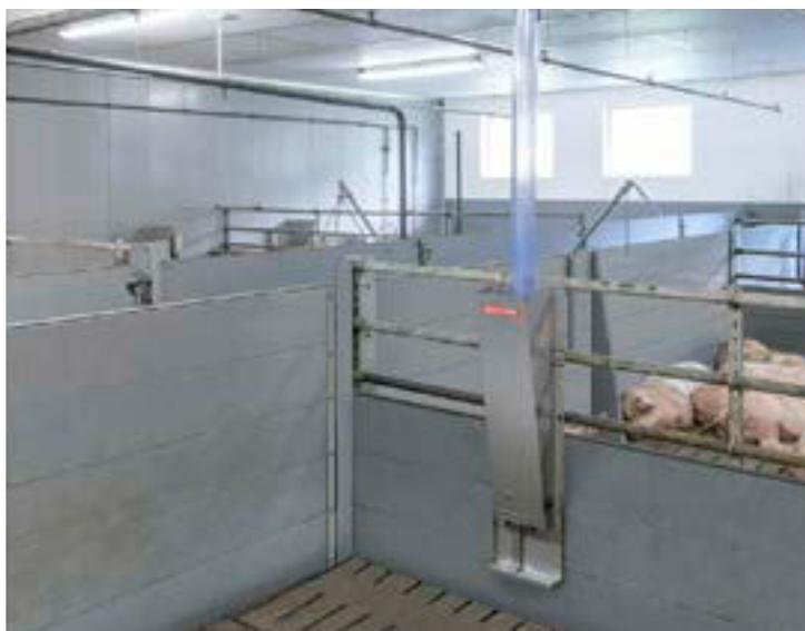
Bild 102: Pelletausomat (rechts) mit automatischer Befüllung und automatische Förderung (links)
