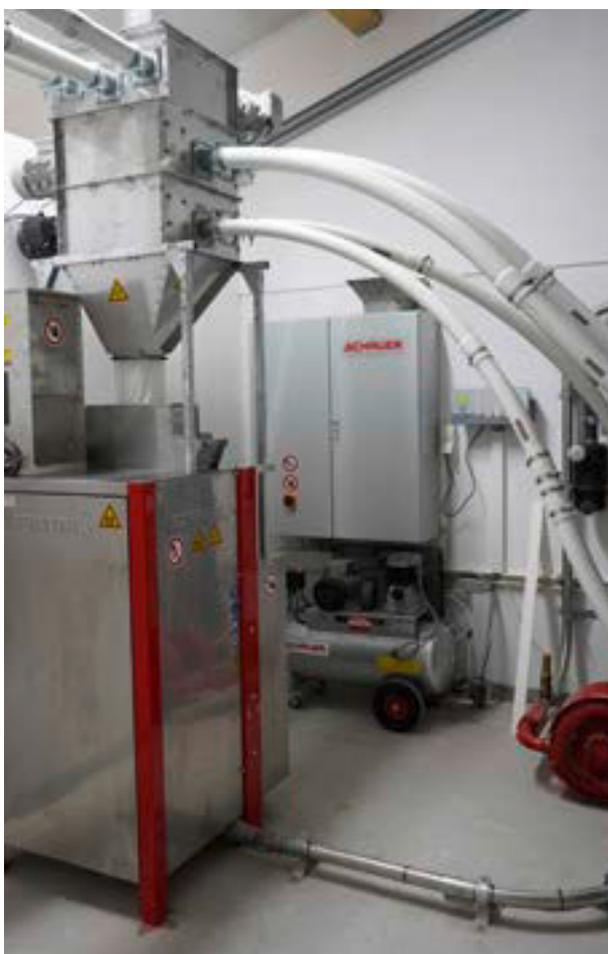
Bild 96: Hybridfütterung – Transport als Trockenfutter, Verteilung als Flüssigfutter
