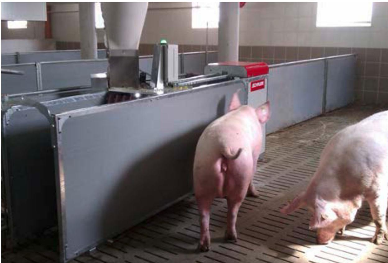
Bild 98: Abrufstation für stabile Großgruppen bis 60 Sauen mit gesteuerter Eingangstür und ungesteuerter Einbahn-Ausgangstür
