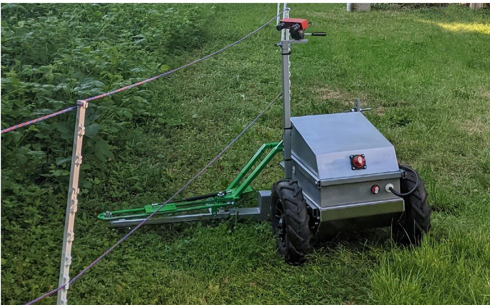
Abbildung 2: Der Rover fährt am Zaun entlang und mäht auch unter dem Zaun. Die Höhe des unteren Leiters beträgt 20 cm über Boden, wie für Wolfsschutzzäune gefordert (© Carsten Bruckhaus).
