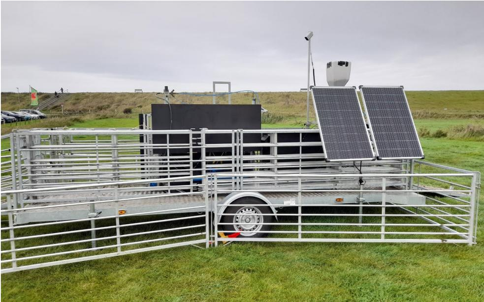
Abbildung 1: Aufbau der mobilen Durchlaufwaage auf der Weide. Die gesamte Elektrotechnik ist in dem mittigen Kasten untergebracht. Weitere Bauteile sind Photovoltaik-Module und Kamera sowie Futterautomat und Kompressor, die ein wenig von den Photovoltaik-Modulen verdeckt werden (© Hendrik Jasper).
