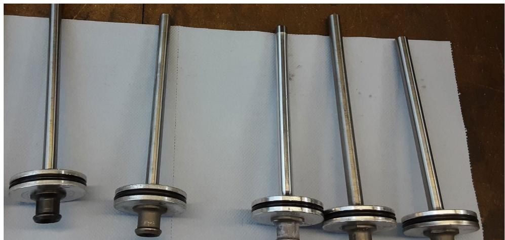
Abbildung 1: Verschiedene Bolzen-Typen eines pneumatischen Bolzenschussgerätes mit unterschiedlichen Längen und Durchmessern (© bsi Schwarzenbek).
