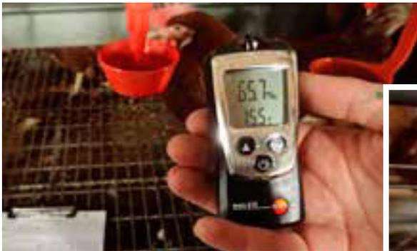
Thermo-Hygrometer zum Messen von Temperatur und Luftfeuchtigkeit
