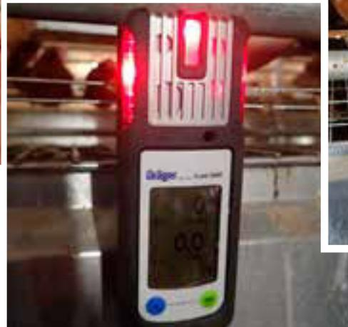
Mit einem Gasmessgerät kann die Konzentration gesundheitsschädlicher Gase im Stall gemessen werden
